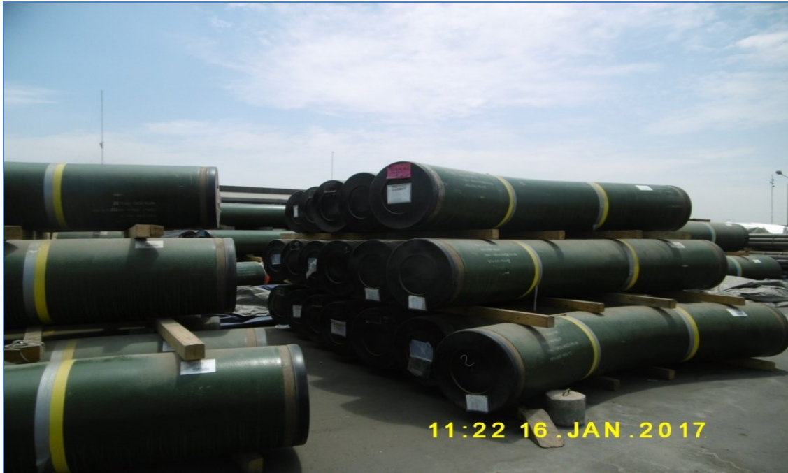
Almacén del Callao Curvas inducidas con los extremos protegidos por tapas, apoyados sobre listones de madera.
