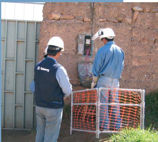
Técnico autorizado realiza la prueba de contraste.
