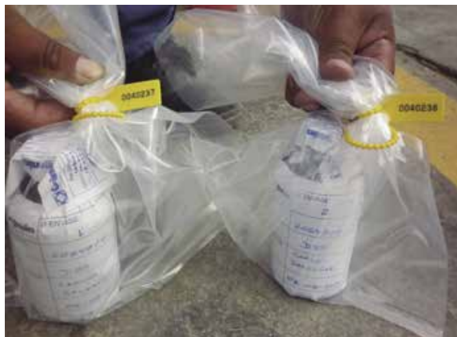
Muestras de diesel B5 s-50 retiradas para el análisis del contenido de azufre
