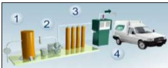
Proceso de abastecimiento de GNV
